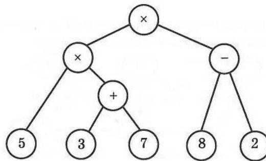
Последовательность выполнения операций определяется при прохождении дерева от листьев к корню (снизу вверх). Последней выполнится операция, отмеченная в корне.
